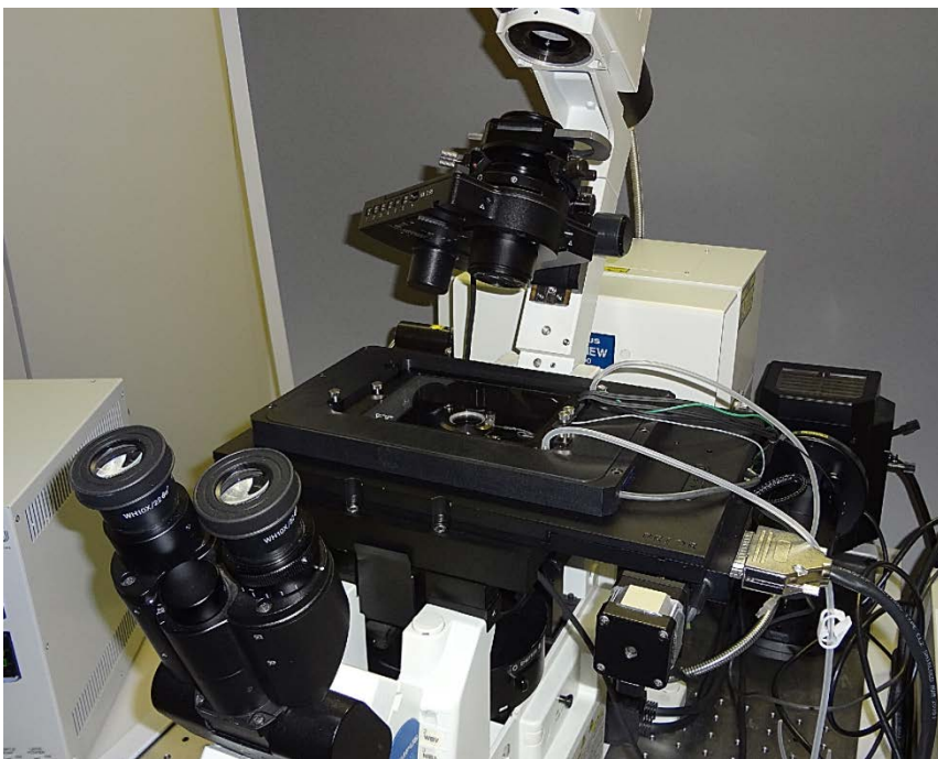
IX81 に装着した H117 ステージ、ピエゾステージ NanoScan Z とインキュベータを搭載
