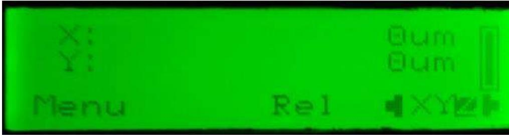
ボタン 4 を押すと、XY の表示が白に反転し、右ホイールで X 軸、左ホイールで Y 軸の微調整ができるようになります。
