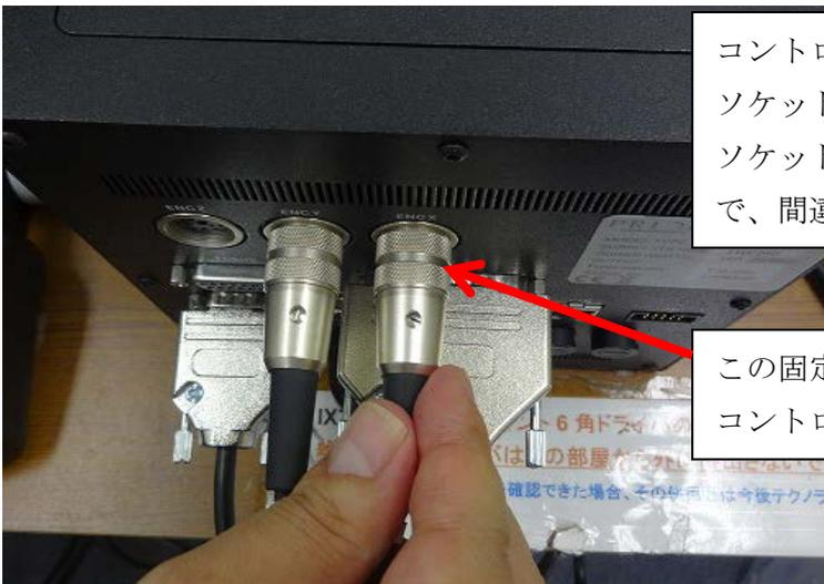
コントローラ背面上部にあるエンコーダソケットに端子を差し込みます。ソケットの配列は、右からXYZの順なので、間違えないようにして下さい。
