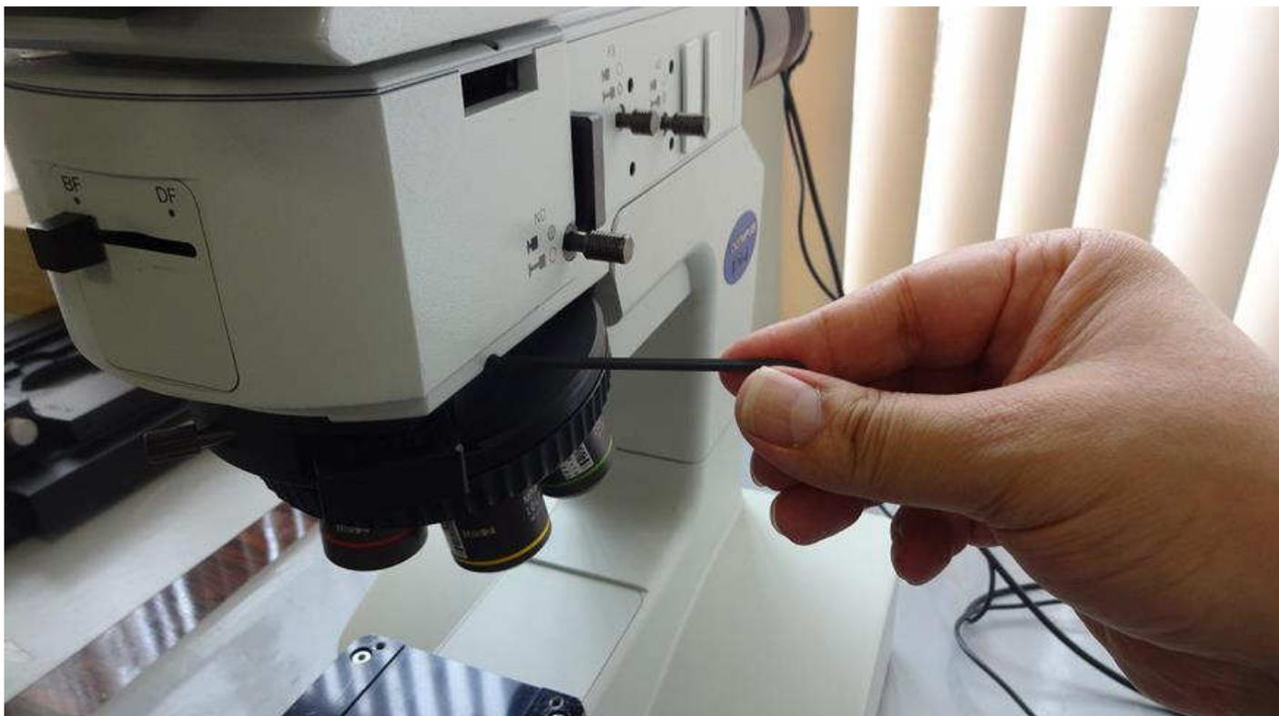
H766 の MX51 への取り付け (M4x8mm ネジ 4 か所)
