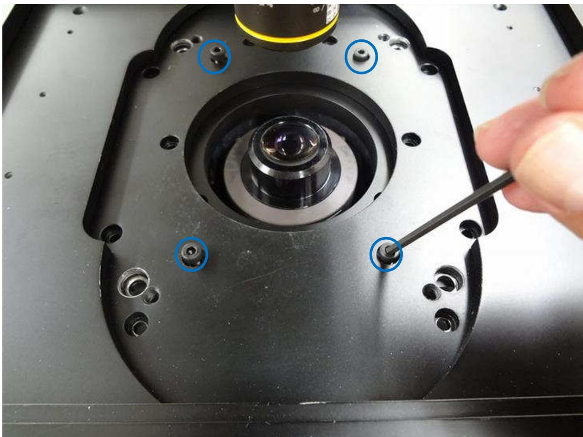
H766 の青丸のネジ穴と、上記写真で示した H116 の青丸のネジ穴の位置が合うように H116 の位置を調整し、付属の M4x10 の六角ネジで H766 と H116 を固定
