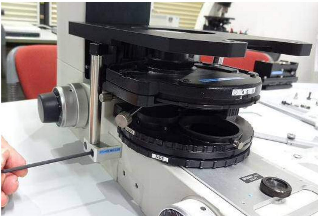
この支柱とステージ取付けアダプタを、ネジで固定して下さい。
