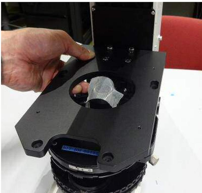
顕微鏡本体左右に、支柱を取り付けます。
