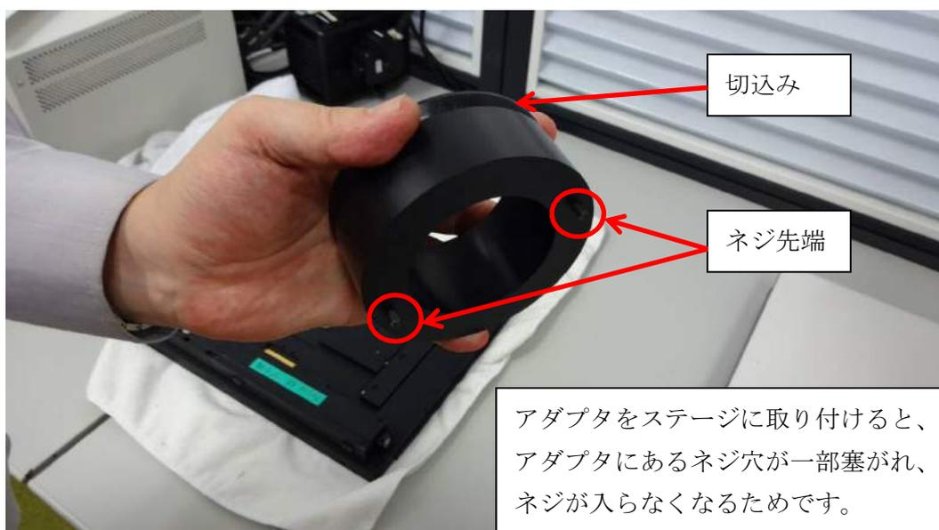
取り付けアダプタを、電動ステージに固定
