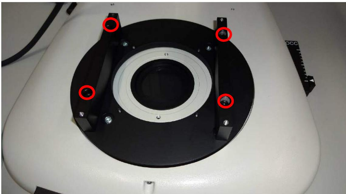
下図の黄色のネジ穴に、ステージ側のネジ穴を配置して、電動ステージを置きます。
