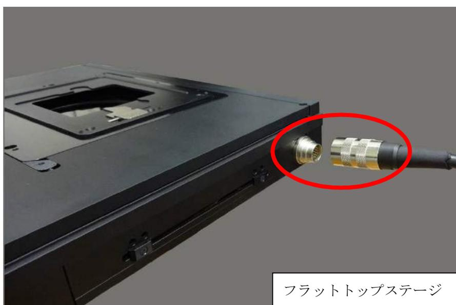
ProScan III コントローラの背面に、ステージとジョイスティックのケーブルを接続します。
