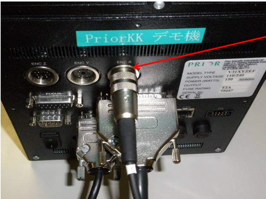
プラグをソケットに入れるだけでは、ここに隙間ができるので、この隙間がなくなるよう回転部分を回し固定して下さい。
