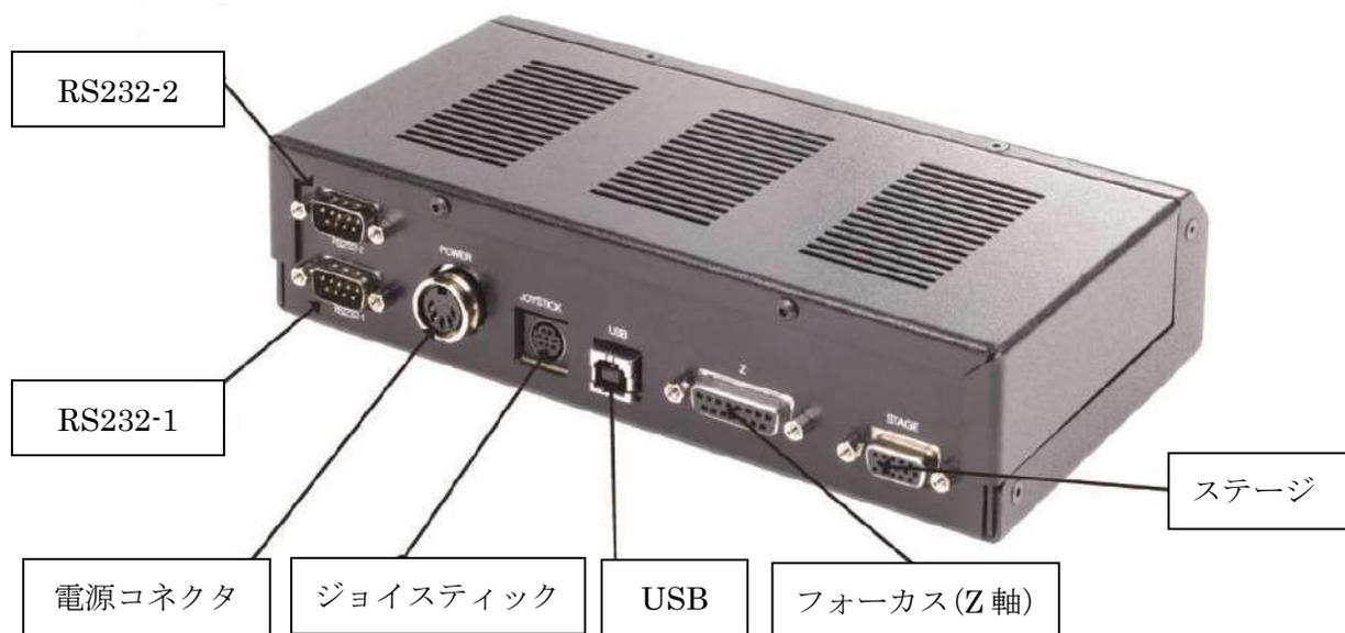
下記の写真のように、フォーカスドライブ、ジョイスティック、電源ケーブルを接続して下さい。
