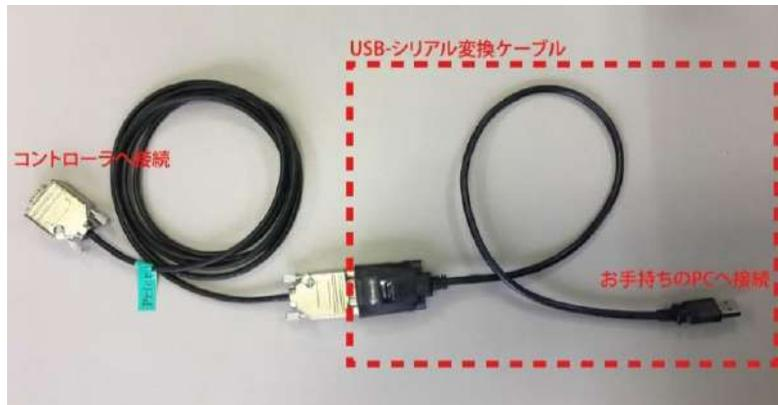
過去には USB 接続の修正方法をご案内したこともございますが、Windows 8、Windows 10 の環境下では誤認識が頻発したため、上記の変換ケーブルをご利用いただく案に至りました。2023 年 3 月現在では、1 件のみではありますが、Windows の自動アップデート後、それまで可能であった RS232 接続ができなくなり、反対にできなかった USB 接続ができるようになった事例がございました。このように Windows の状態に大きく左右されますが、RS232 ケーブルと USB-シリアル変換ケーブルを用いての PC 接続が安定している事例が大多数であるため、弊社で引き続きこの方法を推奨とさせていただきます。何卒ご理解いただきますようお願い申し上げます。
