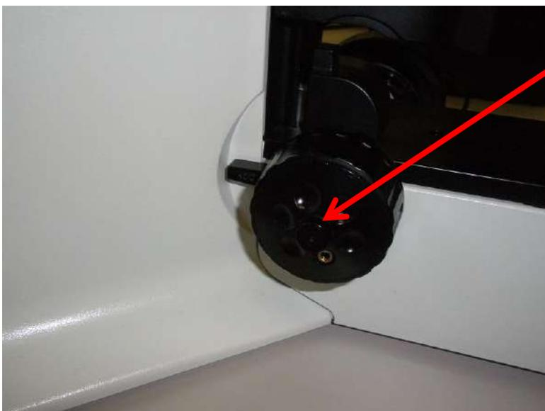
フォーカスドライブを動かした時、取り付けた反対側の（向かって左側）の微動フォーカスノブが回転していることを確認して下さい。
