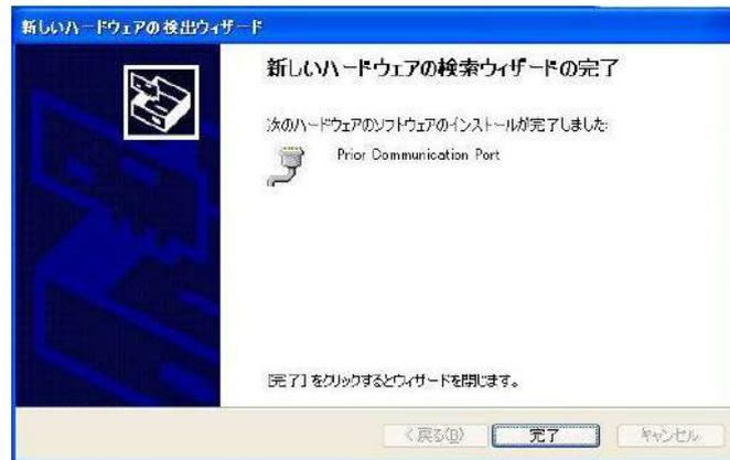
8. 以後、ProScan コントローラを PC に接続すると、PC の COM ポートのうち一つが“USB Serial Port”に割り当てられるようになります。ターミナルソフトウェアでその COM ポートを選択することにより ProScan コントローラと PC で通信ができるようになります。
